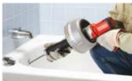
O modelo K-45AF abre rapidamente canalizações entupidas. Avance e recua o cabo sem motor de inversão.
