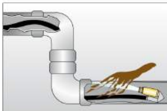
Desobstruir bloqueios e raízes de árvores com Desentupidor 3000.
