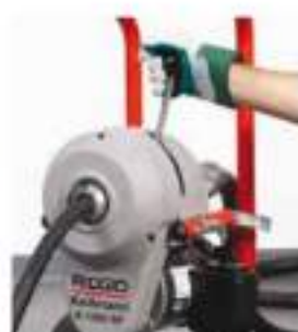
Libertar o punho e o cabo pára automaticamente
