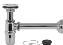
Ref. 03070 Sifón botella lavabo 250 mm. en latón y desagüe lavabo pileta de Ø 80 + tapón y cadenilla de latón, sin rebosadero
